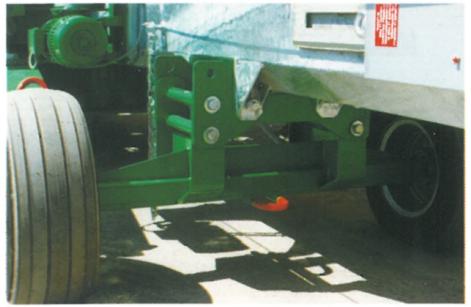
INNESTO ASSALI CON ALTEZZA VARIABILE AXLES COUPLING WITH VARIABLE HEIGHT
